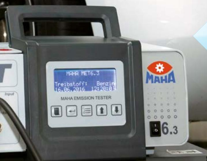
Präzise Analyse der Gaskomponenten HC, CO, CO<sub>2</sub>, O<sub>2</sub> mit Lambdawertberechnung
