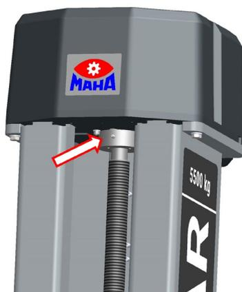
Lubrifier au moins une fois par an le roulement de broche sur la partie supérieure. Pour cela, amener le chariot de levage dans la position la plus basse, desserrer le capot de la broche sur la plaque supérieure et le retirer. Puis lubrifier le roulement de broche à l'aide du graisseur avec de la graisse multi-usage.
