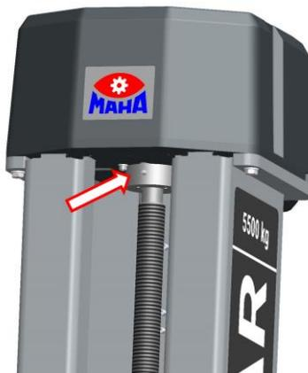
Mindestens einmal jährlich das Spindellager oben schmieren. Dazu den Hub-schlitten in die unterste Position fahren und die Spindelabdeckung an der Kopf-platte lösen und abnehmen. Anschließend das Spindellager über den Schmier-nippel mit Mehrzweckfett abschmieren.
