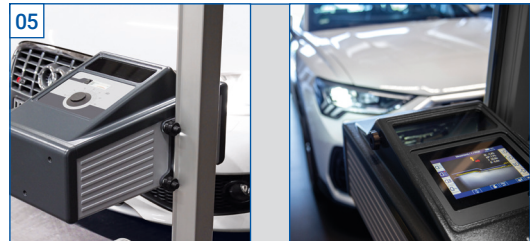
Die Scheinwerfereinstellprüfgerät MLT 1000 und MLT 3000 dienen der schnellen und objektiven Überprüfung und Einstellung von Fahrzeugscheinwerfern. Unebenheiten im Aufstellbereich werden über einen elektronischen Niveauegleich kompensiert (nur MLT 3000).
