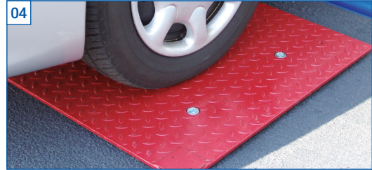
Der Achsspieltester LMS 20.0 dient zur zuverlässigen Ermittlung von Mängeln und Verschleiß an Lenkungsteilen, Radlagern, Federung und Aufhängung durch gegenläufige Quer- und Längsbewegung der Prüfplatten. Ein Automatikmodus sowie weitere unterschiedliche Betriebsmodi ermöglichen die unkomplizierte Bedienbarkeit des LMS 20.0
